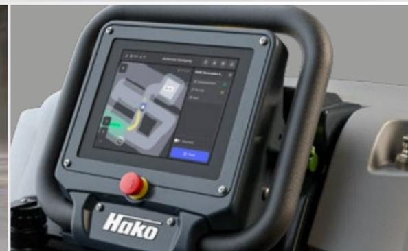
Technik, die lernt: Mapping-Technologien ermöglichen die Erfassung und Speicherung von Routen während der Reinigungsfahrt. Über einen 8-Zoll-Touchscreen kann die Maschine intuitiv bedient und programmiert werden.
