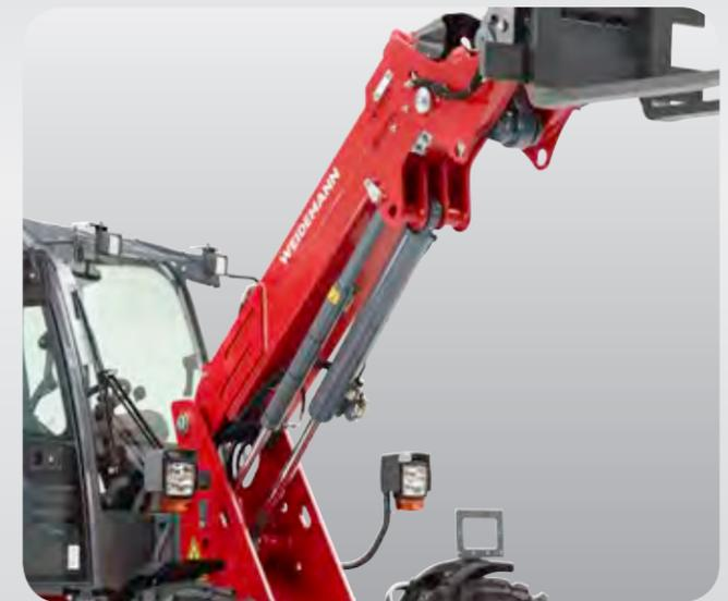
Stabilität. Bei Teleskopradladern und Teleskopladern ist ein leistungsstarker Hubzylinder verbaut. Die Größe der Hydraulikzylinder ist immer an die jeweilige Maschinengröße angepasst. Das schont Maschine und Material.
