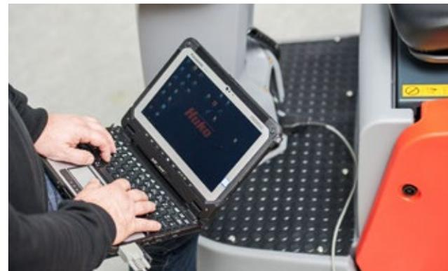
Einfacher Zugang zur Diagnose-Schnittstelle für
